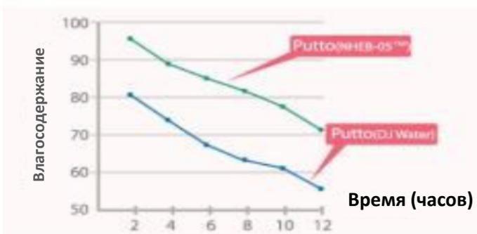
Тест на впитывание (NHEB-05™ против деионизированной воды)
